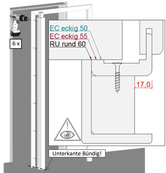
**2. Laufschiene montieren**
