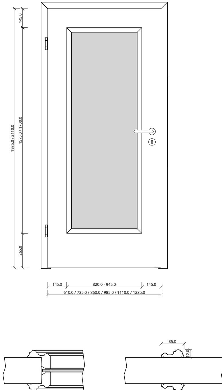
Maße gelten für gefälzte Elemente, bei stumpfen Elementen müssen seitlich und oben 13mm abgezogen werden
