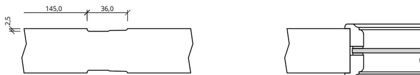
Maße gelten für gefälzte Elemente, bei stumpfen Elementen müssen seitlich und oben 13mm abgezogen werden
