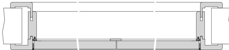
$TB \text{ Breite} = (\text{Futterplattenaußenmaß} - 33,0) / 2$       $TB \text{ Breite} = (\text{Futterplattenaußenmaß} - 33,0) / 2$
