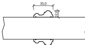
Maße gelten für gefälzte Elemente, bei stumpfen Elementen müssen seitlich und oben 13mm abgezogen werden
