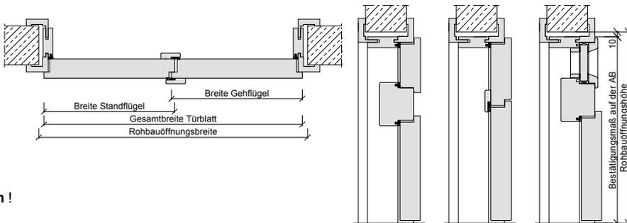
Rohbauöffnungshöhe bei GH max. 2760 mm !
