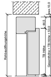
Rohbauöffnungshöhe bei GH max. 2760 mm !
